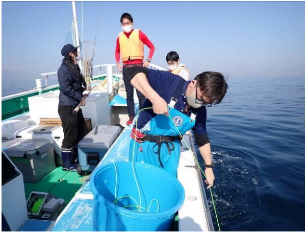
写真 2-① DU300 のケーブル線りの様子
