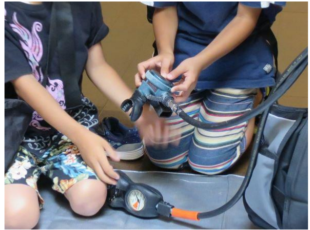
レギュレーターから空気を出すと残圧計が動くことを確認している様子
