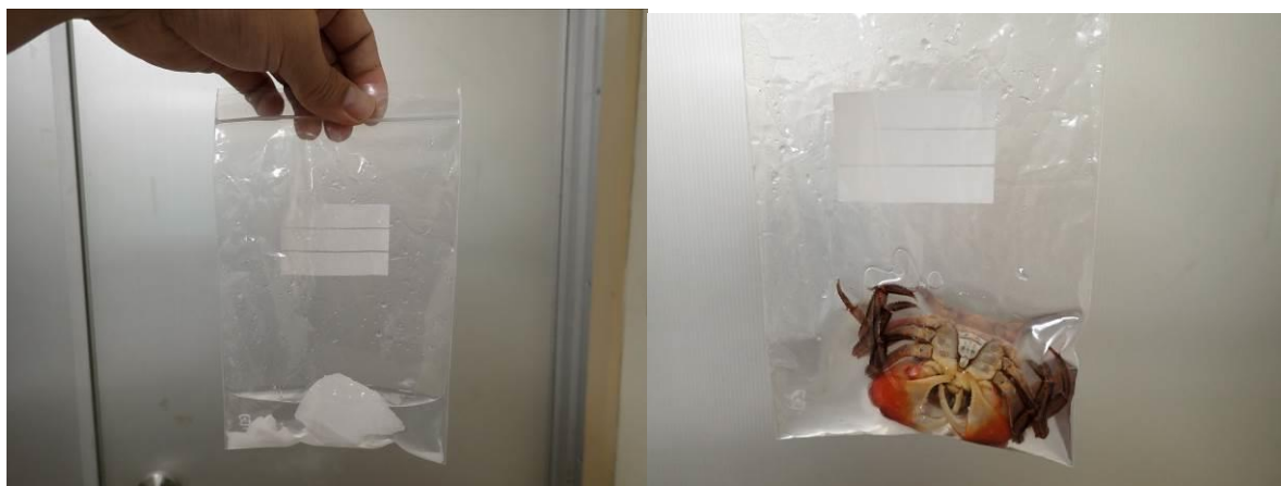
ポリエチレングリコール等で調製した含浸液（左）と含浸液へ投入したカニ（右）
